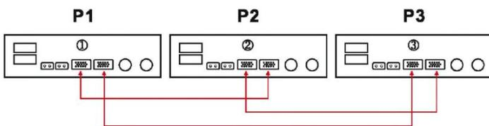
**Два инвертора в фазе P1, и по одному инвертору в фазах P2 и P3**
