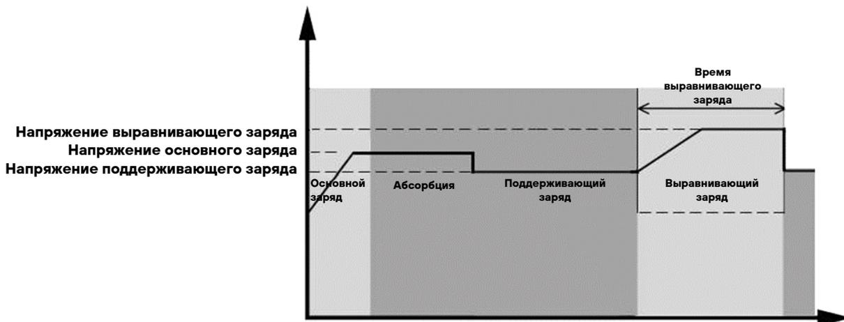
Однако в режиме выравнивания, когда проходит время выравнивания аккумулятора и напряжение аккумулятора не возвращается к точке выравнивающего напряжения, контроллер ЗУ будет увеличивать время выравнивания аккумулятора до тех пор, пока напряжение не достигнет напряжения выравнивания. Если напряжение аккумулятора все еще ниже выравнивающего напряжения, когда срок продления прошел, контроллер ЗУ остановит выравнивание и вернется к режиму поддерживающего заряда.
