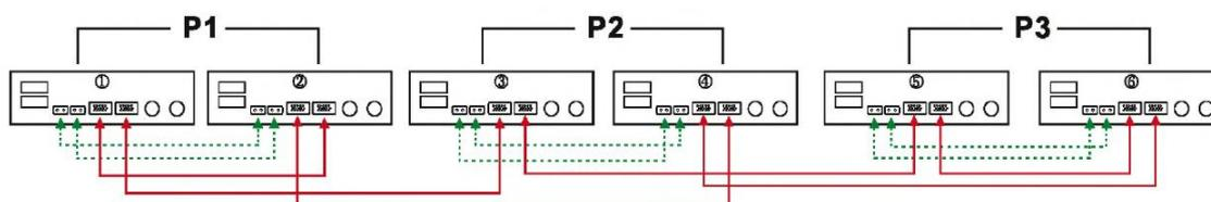
**Три инвертора в фазе P1, и по одному инвертору в фазе P2 и P3**
