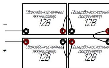
2. Прикрутите наконечник с кабелем к соответствующей клемме аккумуляторного разъема инвертора и убедитесь, что гайки затянуты с моментом 2...3 Н·м. Убедитесь, что полярность подключений аккумуляторной батареи и инвертора правильная, а крепления надежно затянуты.
