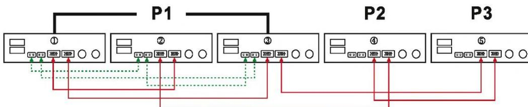
**Четыре инвертора в фазе P1 и по одному инвертору в фазах P2 и P3**
