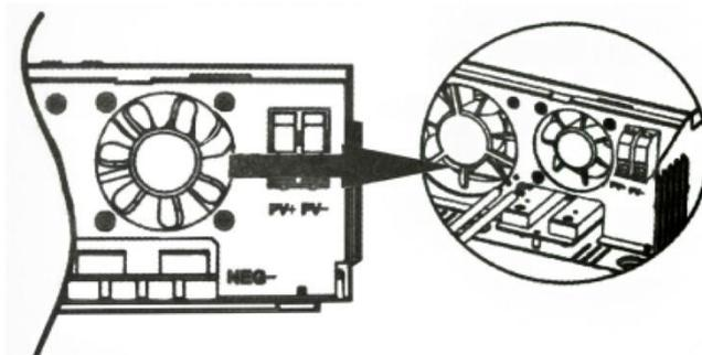
Проверьте правильность полярности подключения соединительного кабеля от солнечных панелей и входа подключения PV-клемм инвертора. Затем подключите положительный контакт (+) кабеля солнечных панелей к положительной клемме (+) входа солнечных панелей устройства. Далее подключите отрицательный контакт (-) кабеля солнечных панелей к отрицательной клемме (-) входа солнечных панелей устройства.
